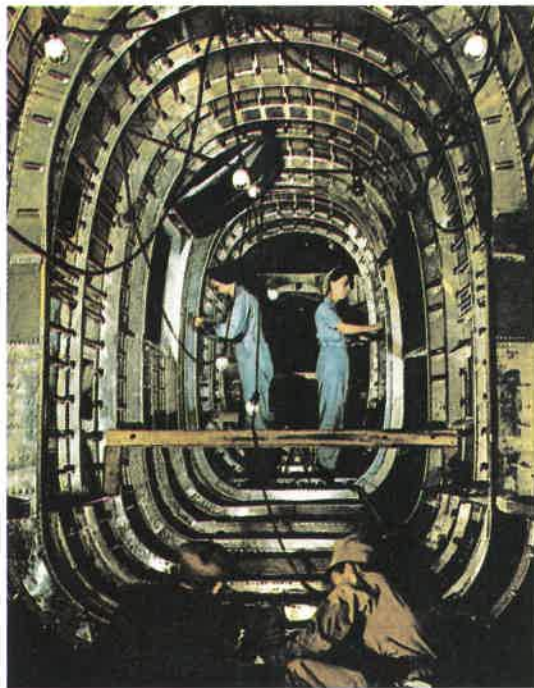
Na levi: delavki v vojnem času opravljata zaključna dela v trupu transportnega letala.
